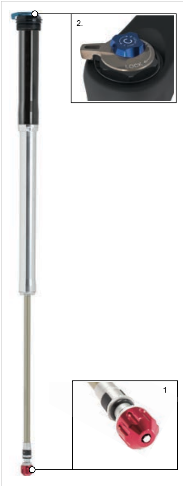
Figura 24: Elementos de mando del HLO
