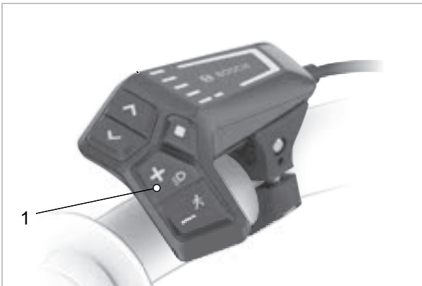
Figura 182: Posición del botón de la luz de marcha (1)
