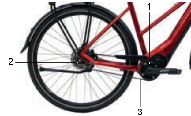
Figura 46: Esquema de la transmisión por correa
