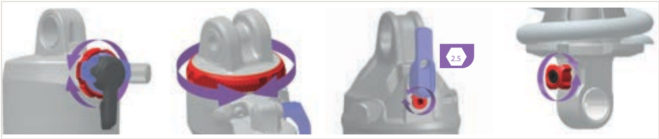
Figura 153: La posición y la forma del regulador de niveles de tracción (amortiguador de la horquilla trasera) (rojo) dependen del modelo
