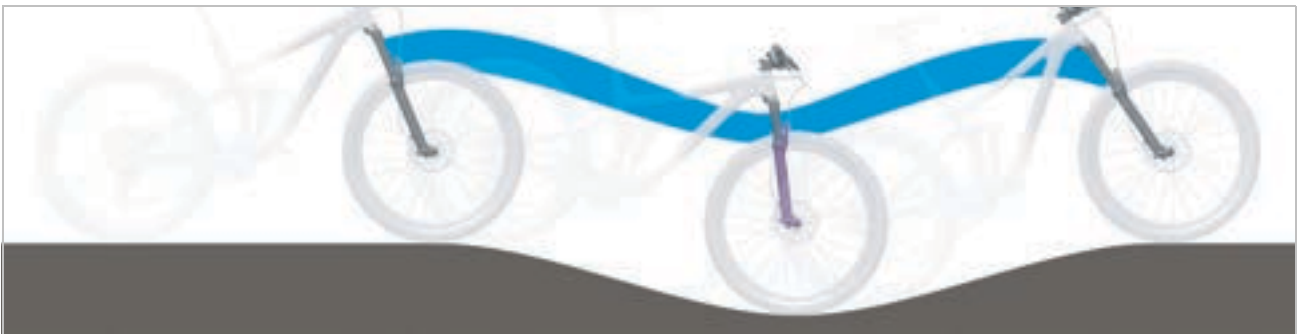
Figura 16: Condición óptima de marcha de la horquilla sobre un terreno accidentado
