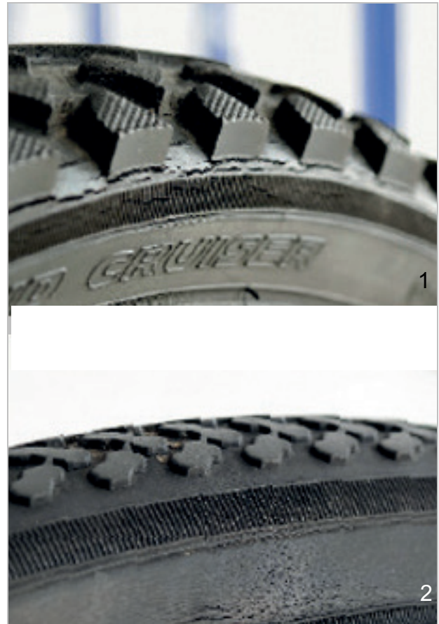
Figura 199: Ejemplos de fisuras por fatiga (1) y fisuras por envejecimiento (2)
