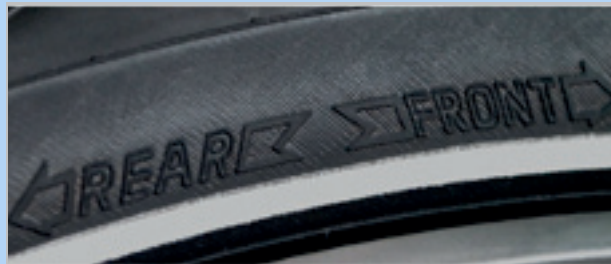
Figura 72: Flecha de sentido de la marcha en cubiertas de MTB
