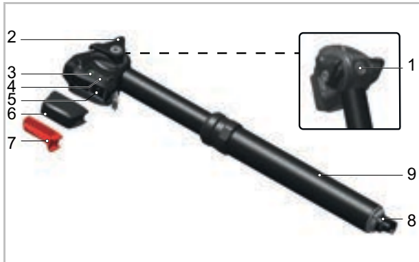
Figura 39: Estructura de la tija de sillín ROCKSHOX Reverb AXS
