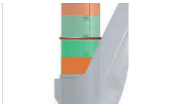
Figura 136: Rango SAG especificado (verde) y rango SAG prohibido (rojo)
