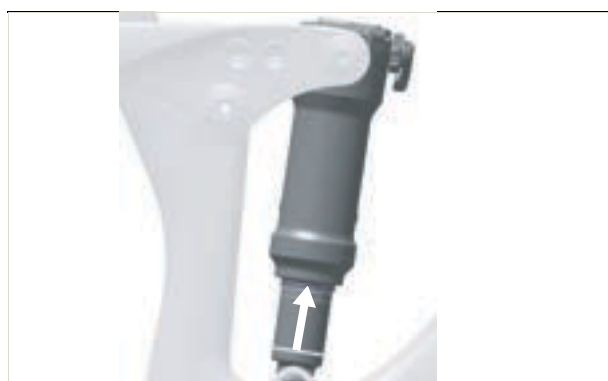
Figura 144: Desplazamiento de la junta tórica en el amortiguador de la horquilla trasera
