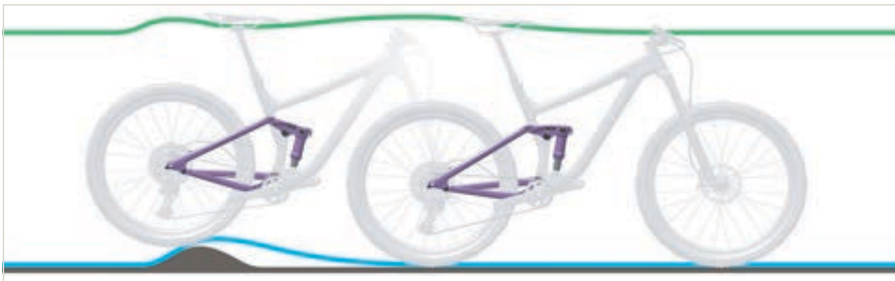
Figura 270: Amortiguación del amortiguador de la horquilla trasera demasiado dura en caso de irregularidades
