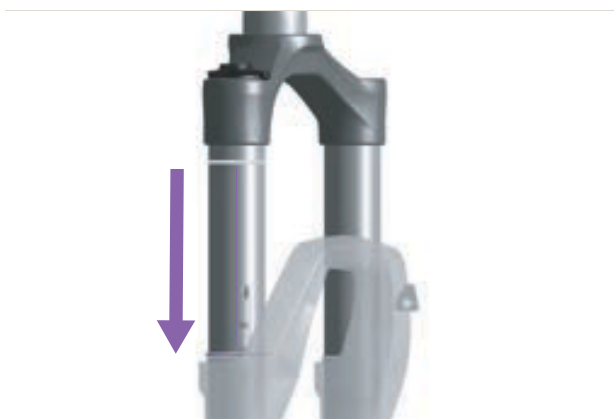
Figura 132: Desplazamiento de la junta tórica de la horquilla de suspensión
