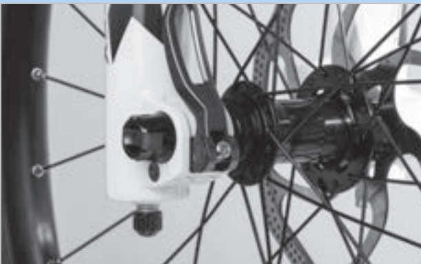
Figura 82: Posición perfecta de la palanca tensora
