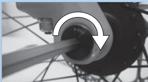
Figura 75: Apriete del eje en la dirección de la flecha
