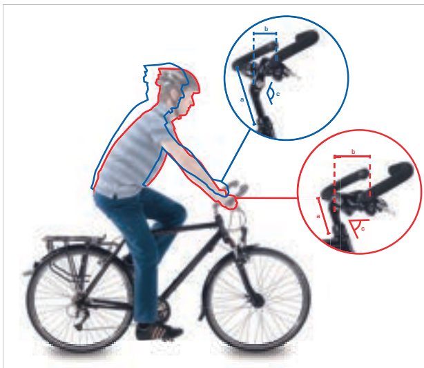
Figura 117: Posición de la bicicleta de ciudad (azul) y la bicicleta de trekking (rojo) mediante la modificación angular
