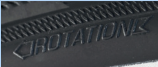
Figura 71: Flecha de sentido de la marcha
