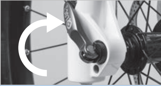
Figura 87: Cierre del cierre rápido
