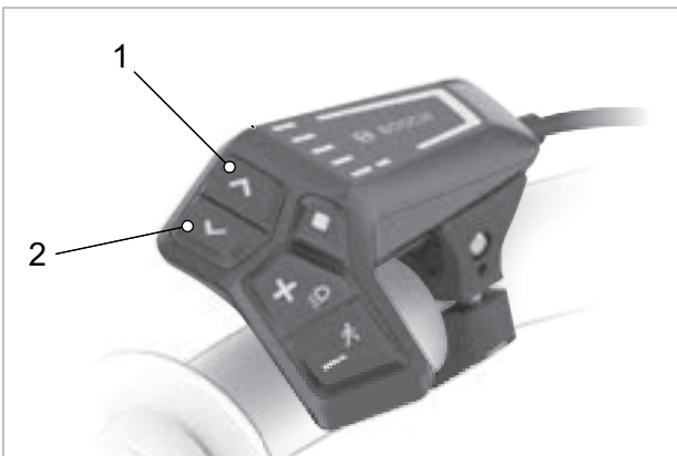
Figura 183: Posición del botón para aumentar el brillo (2) del botón para reducir el brillo (1)
