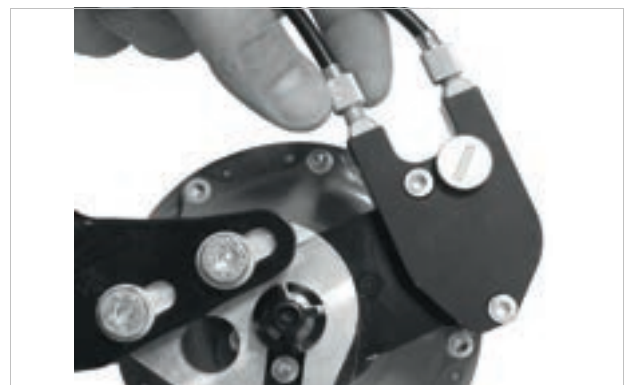
Figura 225: Las versiones de bujes ROHLOFF con activación de cambio externa tienen los dispositivos de ajuste de tensión en la caja de cables que se encuentra en el lado izquierdo
