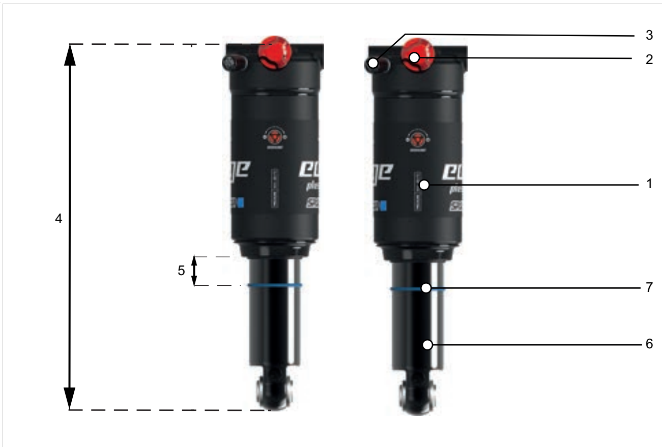
Figura 64: Ejemplo de amortiguador de la horquilla trasera SUNTOUR Edge Plus R Trunnion Mount
