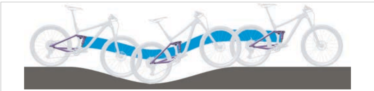
Figura 140: Condición óptima de marcha del amortiguador de la horquilla trasera sobre un terreno accidentado
