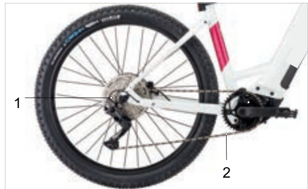
Figura 45: Esquema de la transmisión por cadena con cambio de cadena
