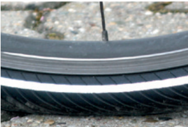
Figura 119: Presión de inflado correcta. La cubierta apenas está deformada bajo la carga del peso corporal
