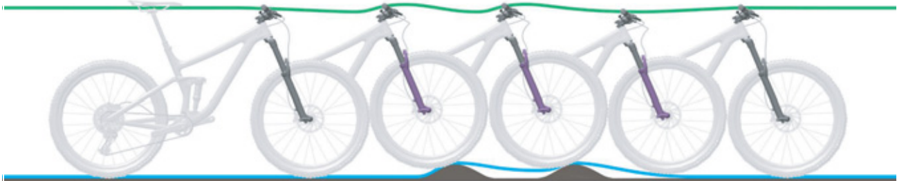
Afbeelding 91: Te langzaam uitveren van de verende voorvork
