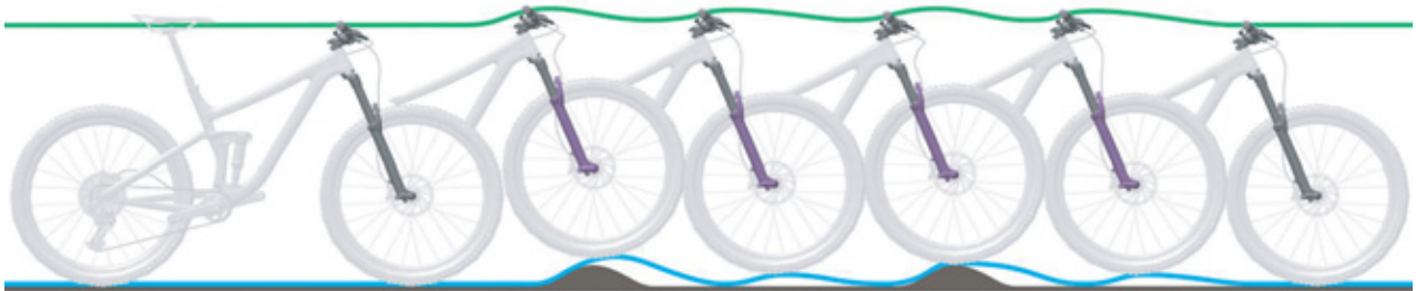
Afbeelding 89: Te snel uitveren van de verende voorvork
