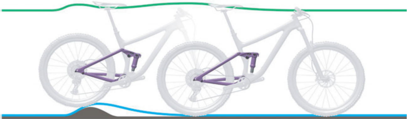
Afbeelding 103: Te harde demping van de achterbouwdemper bij oneffenheden
