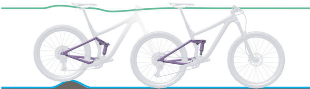
Afbeelding 69: Optimaal rijgedrag van de achterbouwdemper bij oneffenheden
