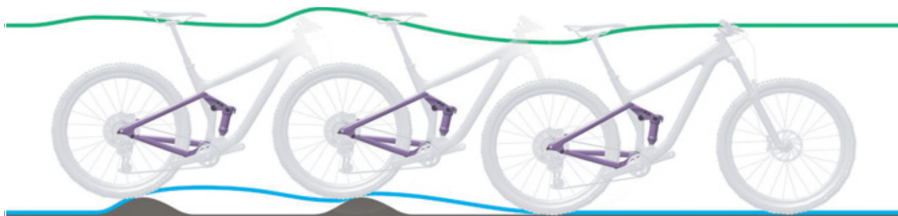
Afbeelding 99: Te langzaam uitveren van de achterbouwdeemper
