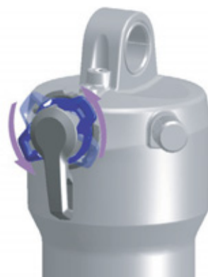
Afbeelding 72: Drukdemperafsteller zachter afstellen
