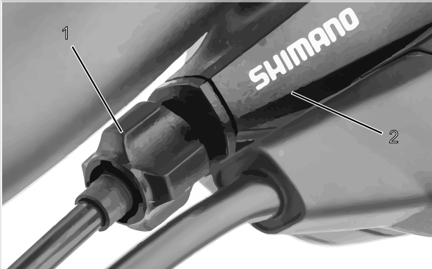
Abbildung 87: Einstellhülse (1) der einzügigen, seilzugbetätigten Gangschaltung mit Schalthebelgehäuse (2), Beispiel
