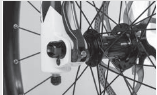
Abbildung 36: Perfekte Lage des Spannhebels
