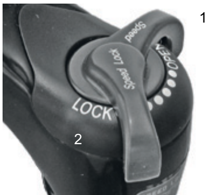
Abbildung 77: Suntour-Druckstufeneinsteller mit den Positionen OPEN (1) und LOCK (2)
