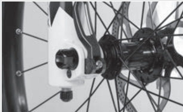
Abbildung 85: Spannkraft des Schnellspanners einstellen
