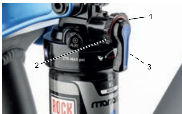
Abbildung 80: Härte des Zugstufen-Dämpfers am Einstellrad (1) des Hinterbau-Dämpfer einstellen
