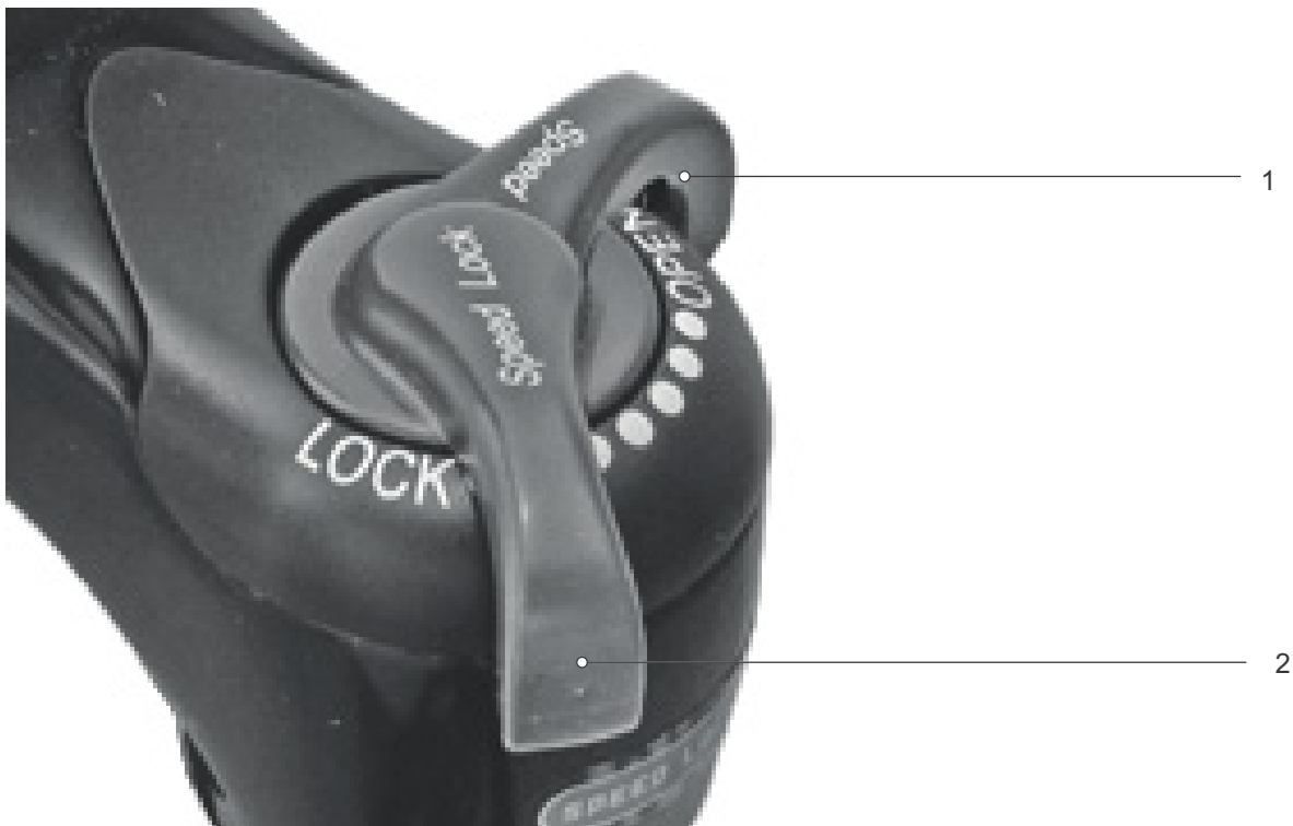
107 paveikslėlis. „Suntour“ kompresiniai amortizatoriai atviroje (1) ir uždaroje (2) padėtyje
