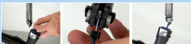
188 paveikslėlis. Įstatykite ir įstumkite balnelio stovą
