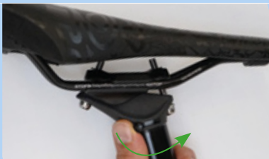
181 paveikslėlis. Atidarykite aukščio reguliatorių
