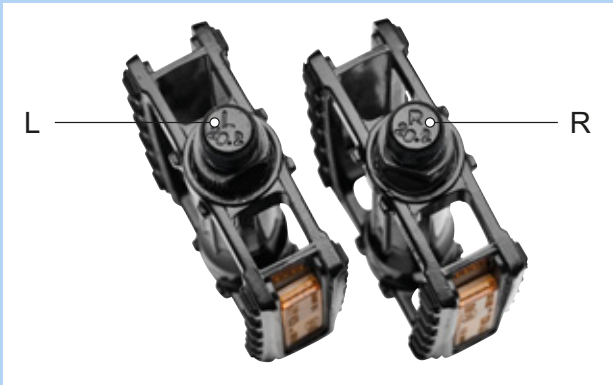
52 paveikslėlis. Pedalų ženklinimo pavyzdys
