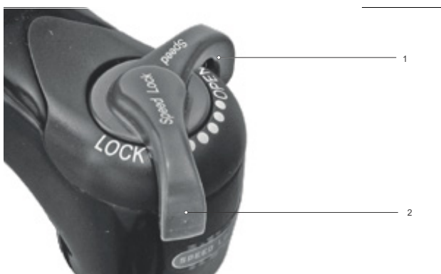
199 paveikslėlis. Kompresijos reguliatorių nustatykite minkštesnėje padėtyje
