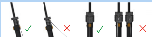
157 paveikslėlis. Teisingas ir neteisingas Bowdeno trosu traukimas
