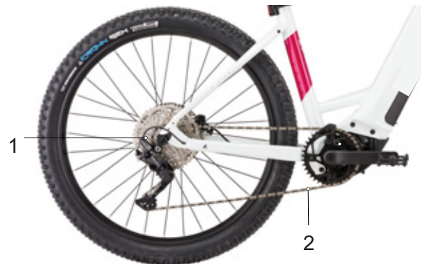
26 paveikslėlis. Grandininės pavaros su pavarų perjungikliu schema
