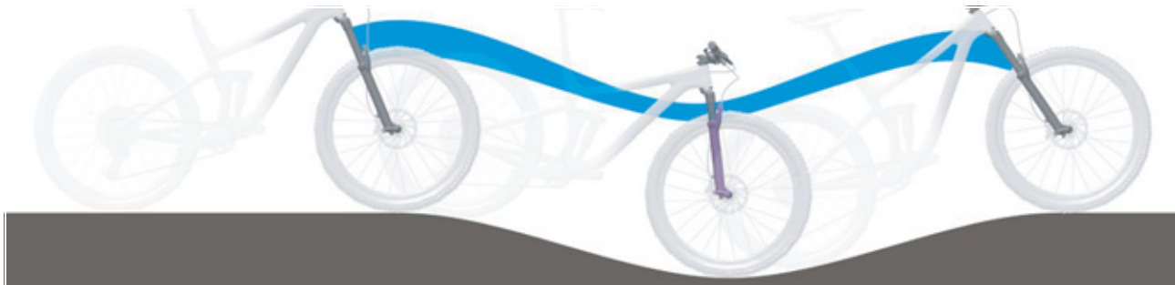
196 paveikslėlis. Ant kalno šakių amortizavimas per minkštas
