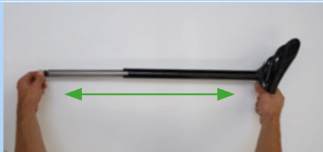
182 paveikslėlis. Ištraukite balnelio stovą
