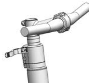
110 paveikslėlis. „All Up“ su atidaryta vairo iškyšos įtempiamąją svirtimi
