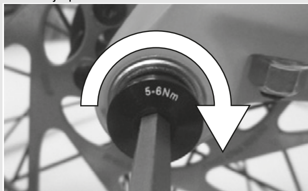
Obr. 23: Utažení pojistného šroubu
