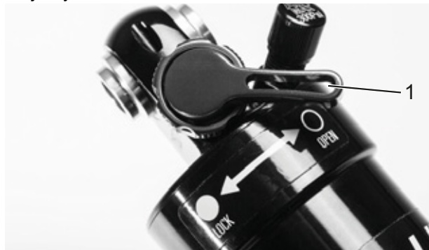
Obr. 65: Nastavovací šroub komprese Suntour otevřený (1)
