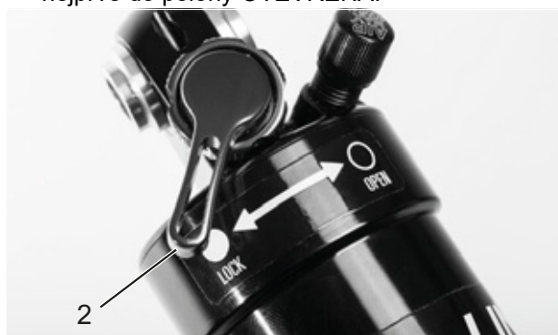
Obr. 66: Nastavovací šroub komprese Suntour zavřený (2)
