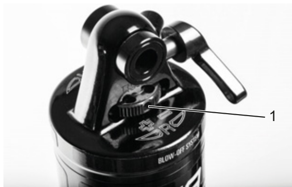
Obr. 55: Nastavovací kolečko odskoku Suntour (1) na tlumiči zadního odpružení
