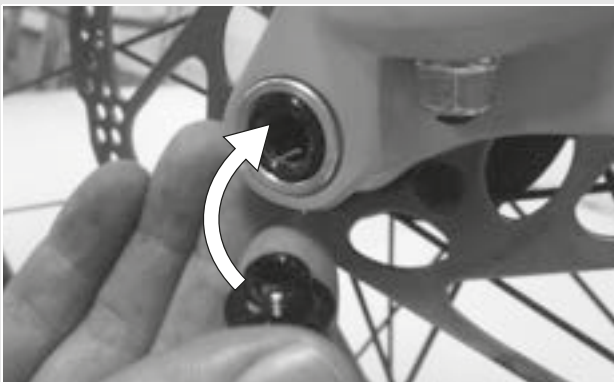
Obr. 22: Zasuňte páku rychloupínáku do osy
