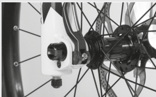
Obr. 72: Nastavení upínací síly rychloupínáku
