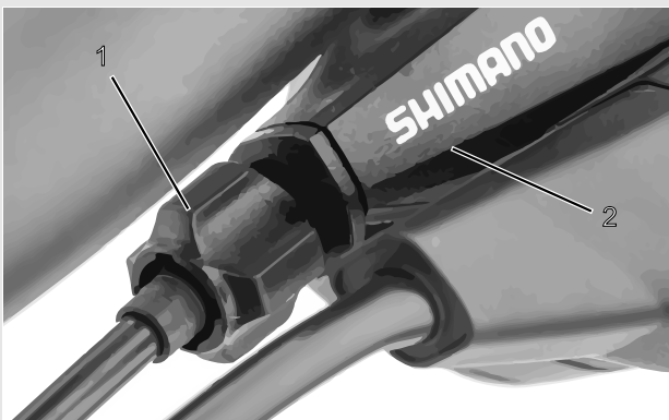
Abbildung 41: Einstellhülse (1) der einzügigen, seilzugbetätigten Gangschaltung mit Schalthebelgehäuse (2), Beispiel
