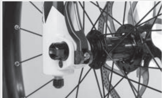
Abbildung 39: Spannkraft des Schnellspanners einstellen
